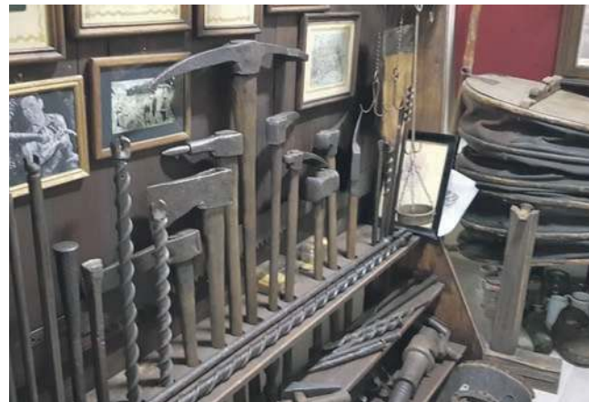
Kolekcja dawnych narzędzi górniczych. W tle miech używany niegdyś do wietrzenia wyrobisk
