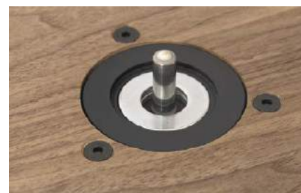
Odwrócone łóżyisko z ceramiczną kulką pracuje lżej dzięki systemowi magnesów, zmniejszającemu nacisk talerza.
