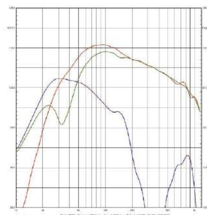
Rys. 4c Charakterystyki sekcji niskotonowej, nisko-średniotonowej i charakterystyka zespołu (poniżej 1 kHz, pomiar w polu bliskim).
