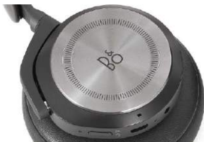
Pod kapselką prawej muszli znajduje się panel dotykowy, odpowiadający za większość funkcji.
