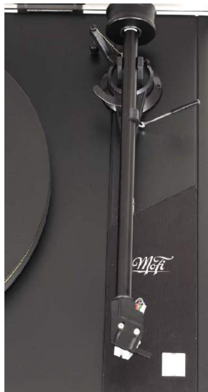
Ciężarek układu anti-skating zawieszono na pomarańczowym sznureczku.
