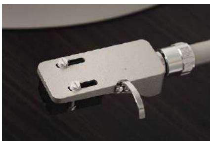
Podobnie jak w wielu japońskich gramofonach, główka jest dokręcona do rurki i można ją wymienić.
