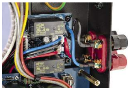
Zabezpieczenia (przełączniki) wyjść to jedno z udoskonaleń w najnowszej wersji A1.
