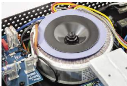
Zasilacz bazuje nadal na transformatorze toroidalnym, w nowym modelu większym niż poprzednio.
