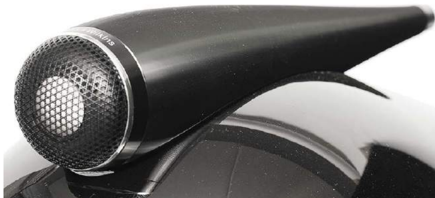
Długa obudowa służy wytłumieniu fali od tylnej strony kopułki bez prowokowania odbić – zgodnie z koncepcją idealnej linii transmisyjnej.
