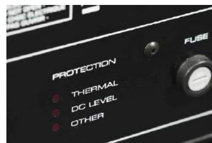
Diodowy wskaźnik systemów zabezpieczających pozwala zweryfikować jaka była przyczyna wyłączenia wzmacniacza.
