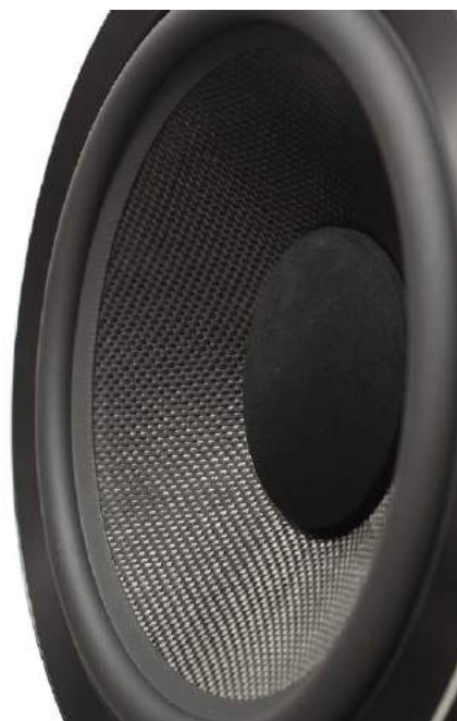
Membrana niskotonowego składa się z kilku warstw tworzących profil aerofoil; jest bardzo sztywna i nie potrzebuje już wiązania dużą nakładką przeciwpyłową, na miejscu której pojawiła się „wkładka antyrezonansowa”.
