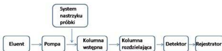
Rys. 2. Blokowy schemat budowy chromatografu
