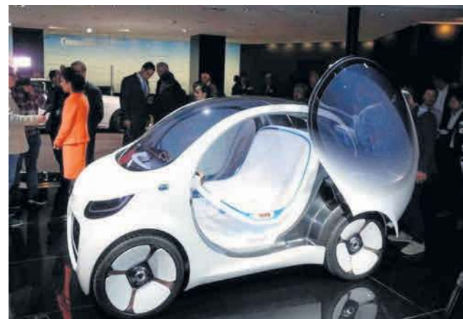
Autonomiczny samochód Smart Vision EQ fortwo korzysta z akumulatora litowo-jonowego o pojemności 30 kWh. „Niepracujący” pojazd samoczynnie przejeżdża do stacji ładowania, aby „zatankować” prąd, lub alternatywnie może zaparkować przy stanowisku indukcyjnym, służącym jako źródło zasilania.
