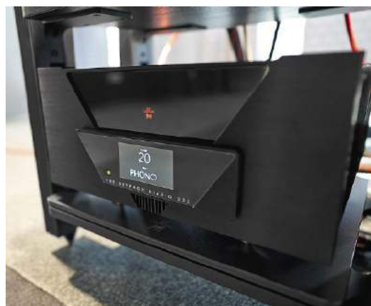
Umarł Diabło, niech żyje Diabło – referencyjny wzmacniacz zintegrowany. Model 300 zastępuje 333, a jego symbol wskazuje na moc – w jednym kanale przy 8 omach, pełny potencjał to 2 x 666 W przy 4 omach i 2 x 1100 W przy 2 omach. Układ dual-mono od wejścia do wejścia, tor zbalansowany, opcjonalne, zaawansowane moduły phono (MM/MC) i DAC.
