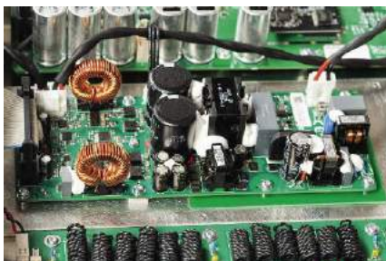
Impulsowe końcówki mocy (wraz z zasilaczami) dostarczyła firma Pascal.
