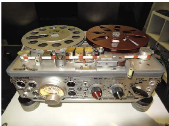
Nagra IV-S – pierwszy stereofoniczny magnetofon Kudelskiego. W pełni sprawny grał na prezentacjach prowadzonych przez Dirka Sommera, znanego niemieckiego propagatora techniki HiFi, zwłaszcza w jej analogowym wydaniu.
