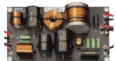
20-cm Seas mógłby pracować jako nisko-średniotonowy; w roli średniotonowego, z podziałem przy 700 Hz w zasadzie „odpoczywa”.
