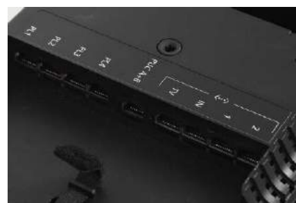
Złącza systemu PowerLink służą do współpracy z dodatkowymi kolumnami B&O, są też aż cztery sieciowe gniazda LAN (jedno specjalnie dla telewizorów LG).
