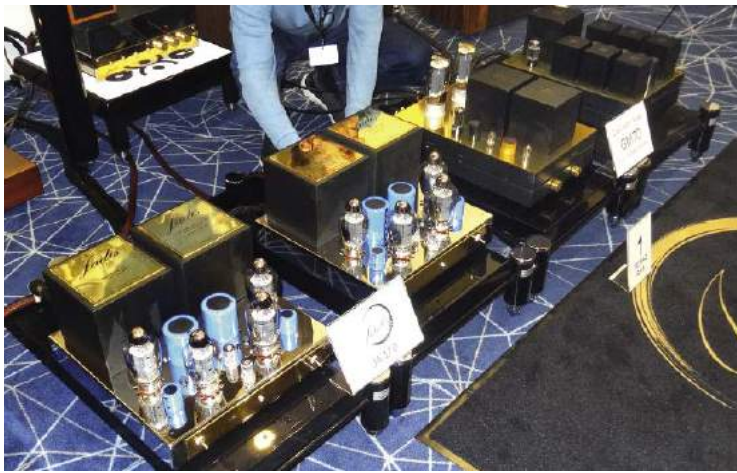
Monobloki Jadis JA170 na lampach KT180 – cztery w podwójnym układzie push-pull oddają 85 W w klasie A. Na drugim planie wzmacniacz Destination Audio Nika, formalnie zintegrowany, ale z odseparowanym zasilaniem.
