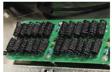
Zdecydowanie autorskim rozwiązaniem jest arsenał obwodów redukujących zakłócenia RFI.
