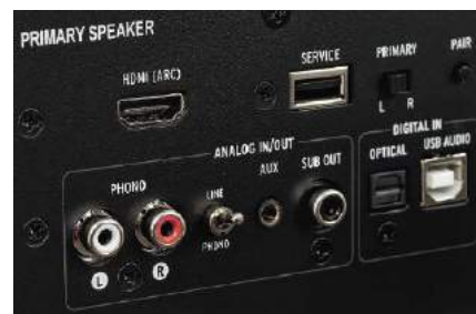
The Sevens nie ma funkcji sieciowych, ale zestaw przyłączeniowy jest imponujący; wejście RCA może przyjmować sygnały liniowe lub gramofonowe (z wkładki MM).
