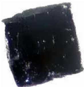
5. Próbką opartego na związkach miedzi nadprzewodnika wysokotemperaturowego
