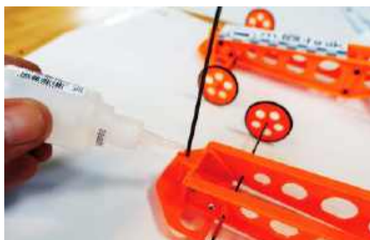
Sprężynę należy dobrze wkleić klejem cyjanoakrylowym
