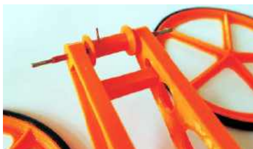
Tylna oś z rolką napędową
