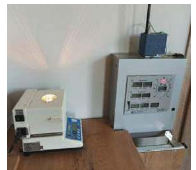
Pracująca wagosuszarka i umieszczony obok rejestrator danych pomiarowych
