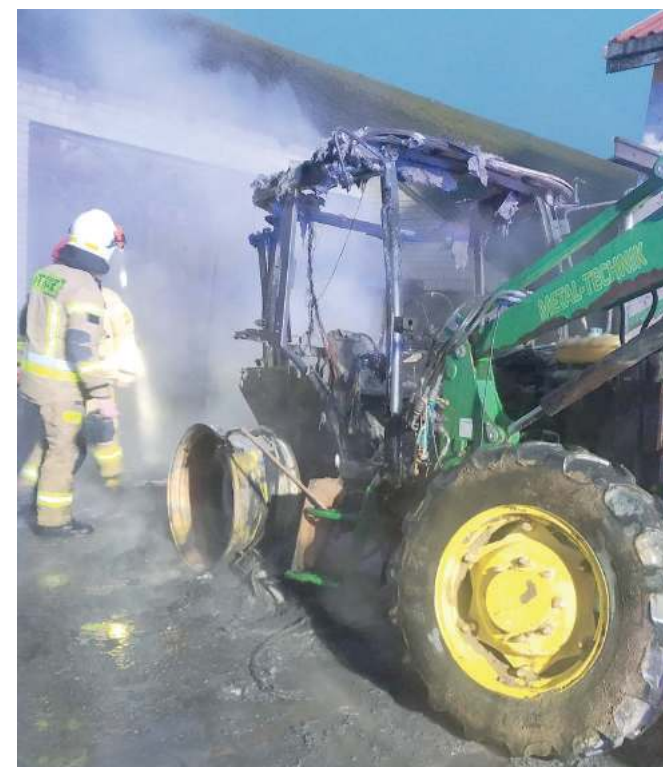
Prawdopodobną przyczyną zapalenia się ciągnika było zwarcie instalacji elektrycznej
