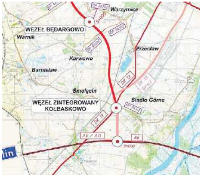
Początek obwodnicy Szczecina na skrzyżowaniu z autostradą A6
