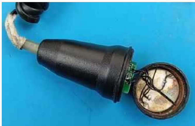
Fotografia 16. Wnętrze głowicy dopplerowskiej współpracującej z detektorem tętna płodu. Widoczny podwójny przetwornik ultradźwiękowy (nadajnik i odbiornik) w postaci płaskiej płytki piezoceramicznej ( https://t.ly/6K7jt )
