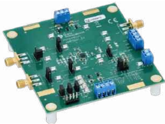
Fotografia 2. Płytkę ewaluacyjną PGA849EVM z układem PGA849 [6]
