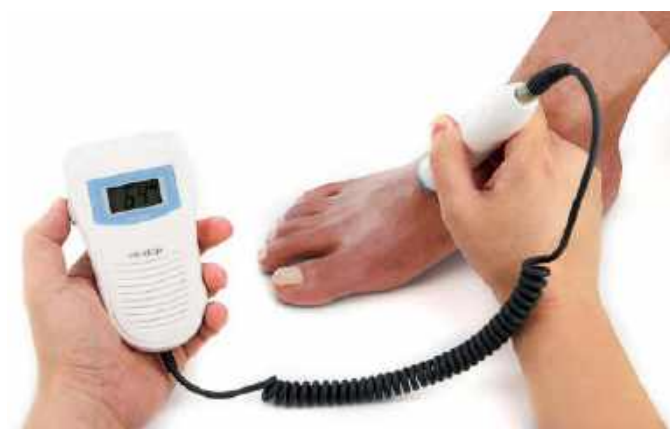
Fotografia 14. Niewielkie urządzenie dopplerowskie do badań przepływów naczyniowych ( https://t.ly/JV2W2 )
