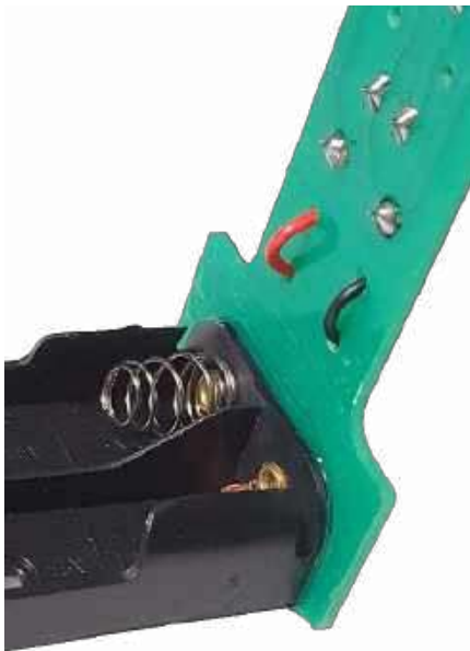
Fotografia 2. Szczegóły montażu koszyka na baterie
