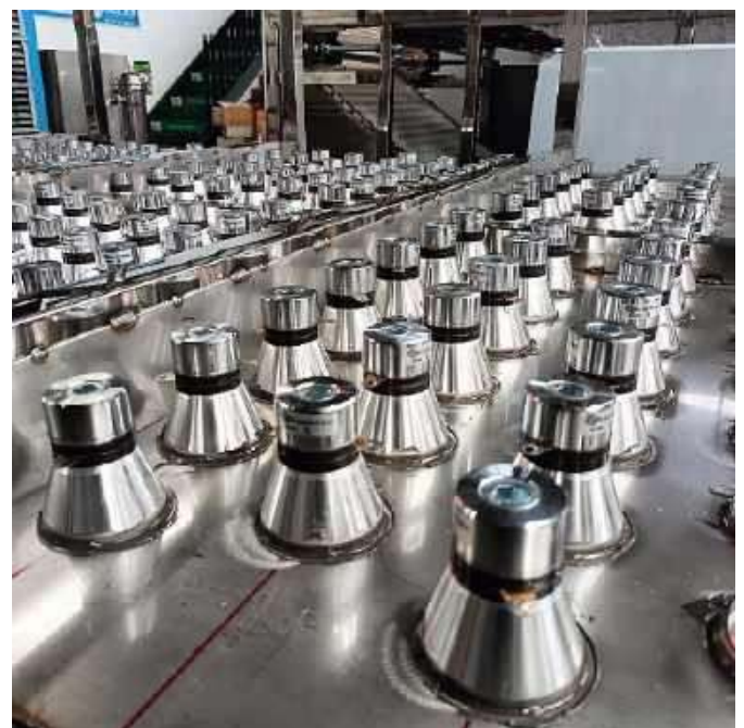
Fotografia 20. Zestaw przetworników zamontowanych do zbiornika przemysłowej myjki ultradźwiękowej dużej mocy ( https://t.ly/R_y3f )
