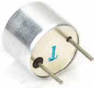
Fotografia 8. Tani nadajnik ultradźwiękowy z widocznym oznaczeniem ( https://t.ly/7esIF )
