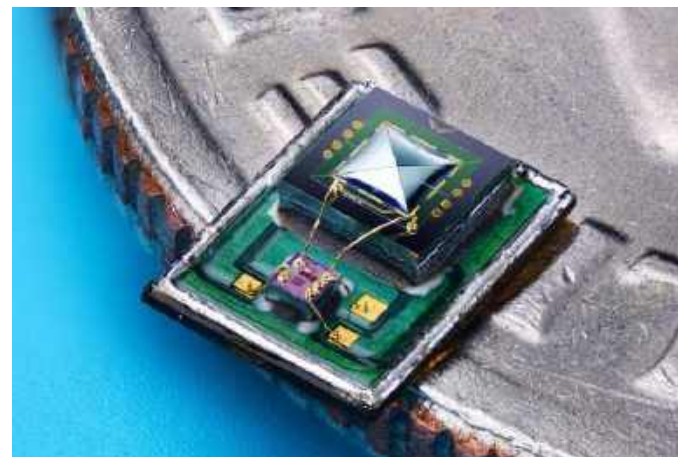
Fotografia 4. Budowa wewnętrzna typowego mikrofonu MEMS ( https://t.ly/ZXhse )
