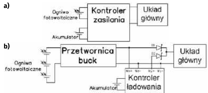
Rysunek 3. Dwa rozwiązania zasilania fotowoltaicznego małej mocy: z kontrolerem zasilania (a) i modułem ładowania akumulatorów z zabezpieczeniem oraz przetwornicą diodową (b)
