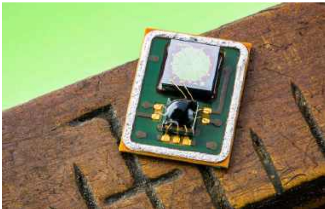
Fotografia 5. Struktura mikrofonu piezoelektrycznego MEMS ( https://t.ly/z8P1y )
