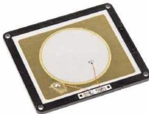
Fotografia 23. Szerokopasmowy głośnik piezoelektryczny o wymiarach 50×46,3×2 mm ( https://t.ly/5_Ot5 )
