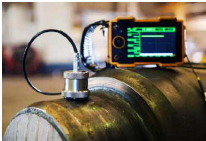
Fotografia 13. Badanie nieniszczące z użyciem przetwornika ultradźwiękowego przyłożonego bezpośrednio do testowanego obiektu ( https://t.ly/QZxSG )
