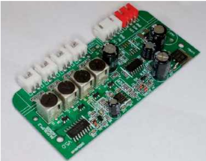
Fotografia 18. Płytkę drukowaną kontrolera taniego, uniwersalnego systemu czujników parkowania. Widoczne miniaturowe transformatory strojone, pracujące w torach nadawczych ( https://t.ly/01Y15 )
