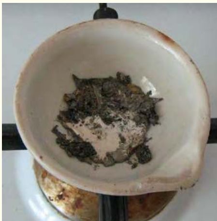
Na powierzchni stopionego ołowiu powstaje nalot tlenku.
