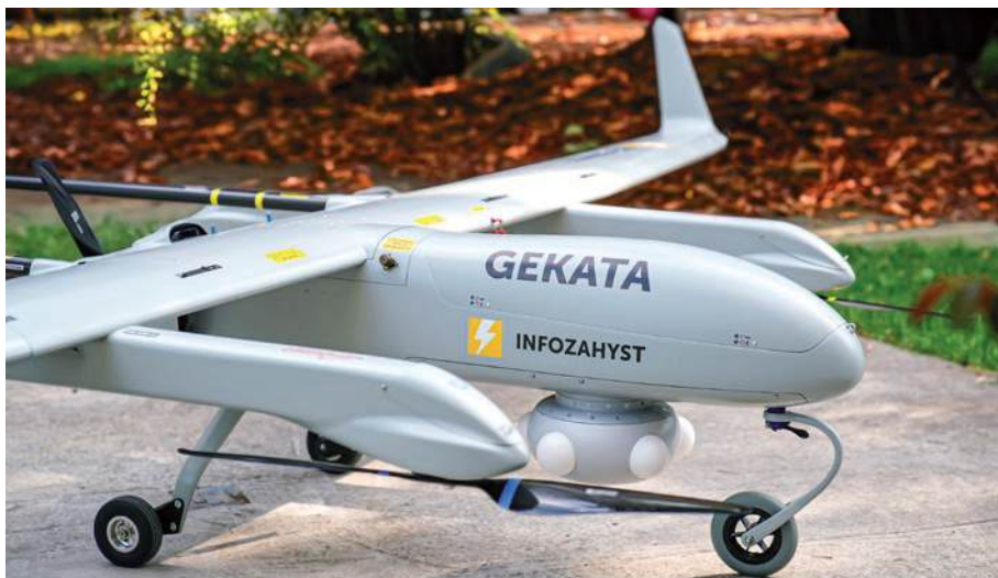
◀ Ukraiński powietrzny bezałogowiec z systemem rozpoznania radioelektronicznego Hekata .
