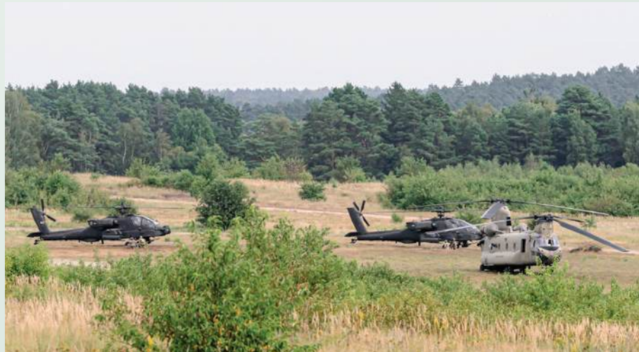
▲ W trakcie ćwiczeń w Drawsku Pomorskim śmigłowce AH-64D były tankowane przez CH-47F Chinook w ramach tzw. fat cow operations. Zdolność do tworzenia mobilnych stref do tankowania i dozbrajania Apacze jest jednym z głównych powodów dla których Lotnictwo Wojsk Lądowych potrzebuje ciężkich śmigłowców transportowych. Zdjęcie: US Army
