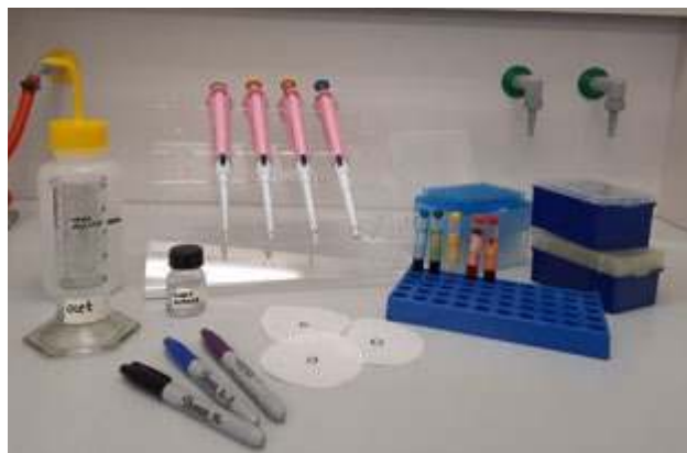
Rysunek 9. Przykładowy zestaw potrzebny do wykonania ćwiczenia dotyczącego rozdzielania składników mieszanin barwników techniką chromatografii bibułowej.
