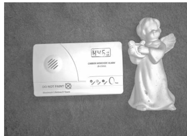
Zadaniem czujnika jest wykrywanie stężenia tlenku węgla w otaczającym nas powietrzu i alarmowanie o tym poprzez uruchomienie sygnału dźwiękowego
