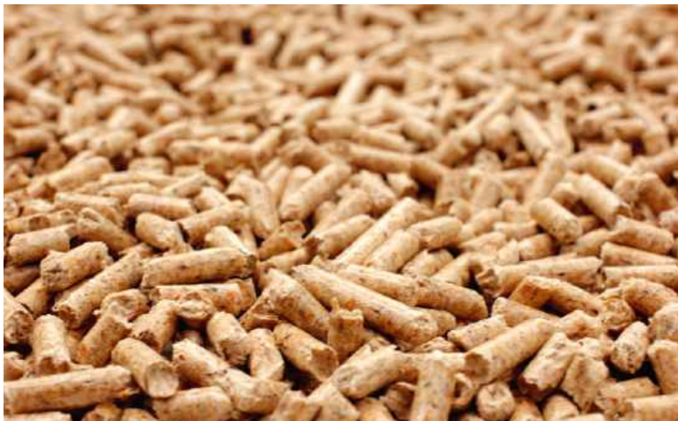
● Pellet to paliwo w postaci granulatu, uzyskiwane z biomasy, np. odpadów drzewnych. ARCHIWUM BD
