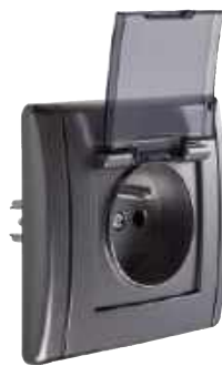
🔌 W łazienkach montuje się gniazda z pokrywą (bryzgoszczelne) i stopniu szczelności IP44. KARLIK
