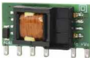
Fotografia 12. Zasilacz subminiaturowy do montażu THT (CUI, http://bit.ly/3qtEas9 )
