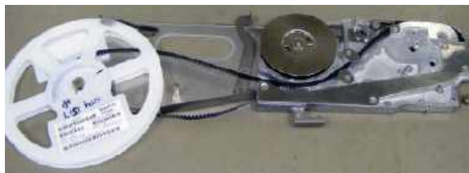
Fotografia 8. Elementy zapakowane w taśmach przeznaczony do maszyny pick and place
