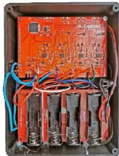
Fotografia 4. Zmontowane płytki umieszczone w obudowie
