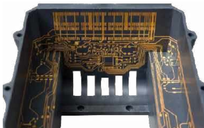
Fotografia 1. Komponent MID z gotową warstwą przewodzącą
