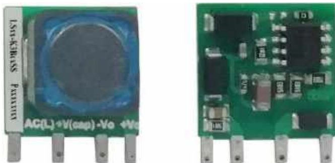
Fotografia 25. Ultraminiaturowy zasilacz nieizolowany LSxx-K3BxxSS marki Mornsun ( http://t.ly/4lfq )
