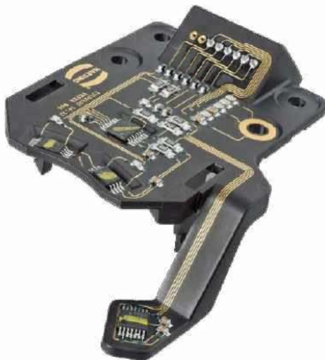
Fotografia 2. Komponent MID z zamontowanymi elementami
