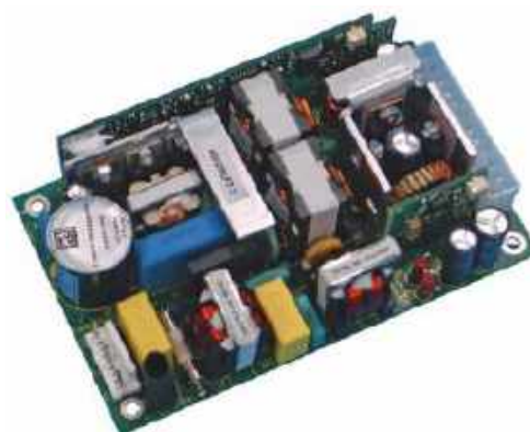
Fotografia 20. Zasilacz modułowy NV-100 marki TDK Lambda ( http://t.ly/hiWG )
