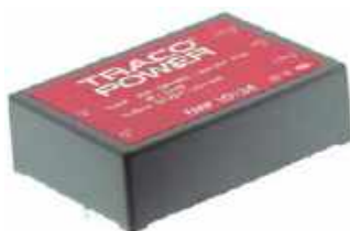
Fotografia 10. Zasilacz kompaktowy do montażu THT (Traco Power, http://bit.ly/3KiPPBW )
