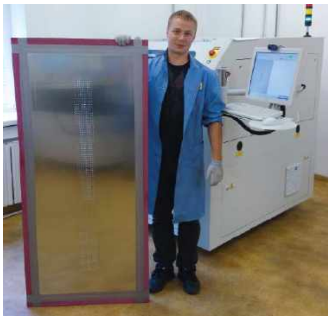
Fotografia 2. Długi szablon w ramie aluminiowej do produktów LED (Semicon Sp. z o.o.)
