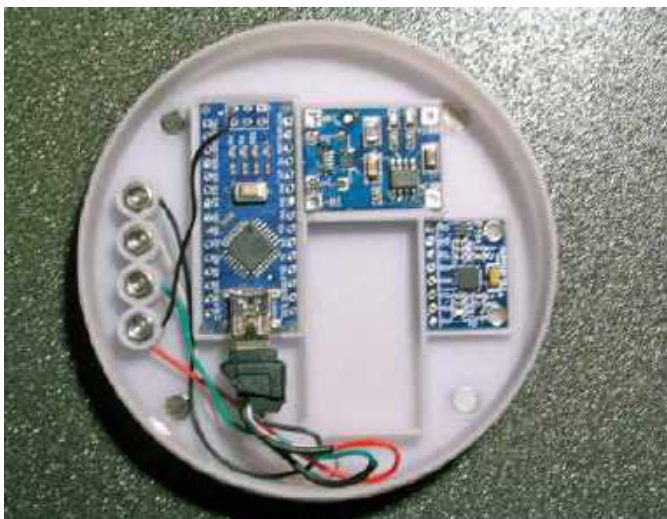
Fotografia 2. Podłączenie modułu z mikrokontrolerem do portu ładowania i rozmieszczenie pozostałych elementów w drukowanej obudowie
