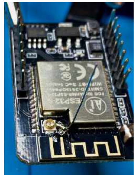
Fotografia 2. Modyfikacja w obwodzie anteny modułu
