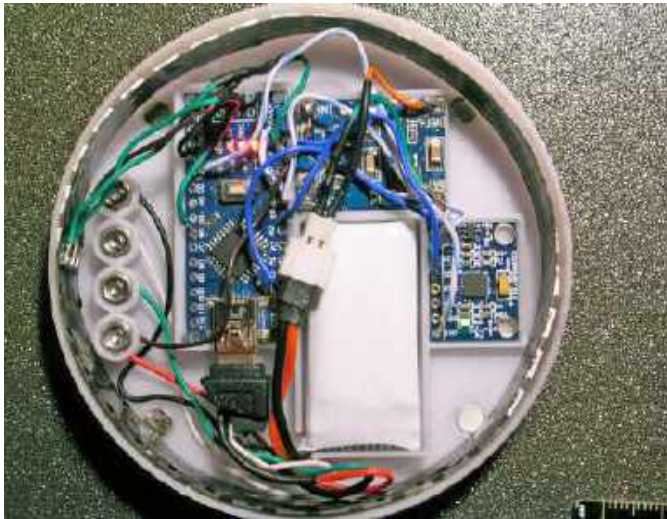
Fotografia 1. Elektronika zamontowana we wnętrzu spinnera
