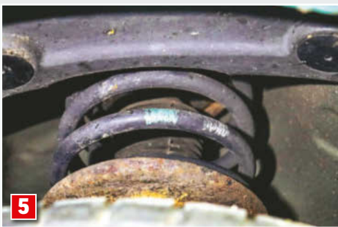
5 PRZEDNIE SPRĘŻYNY. W końcu pękają od korozji i zmęczenia, chyba że zostały już wymienione.
