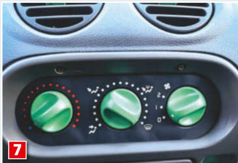
7 POKRĘTŁA I PRZEŁĄCZNIKI. Plastik, z którego wykonano kolorowe elementy, staje się kruchy.
