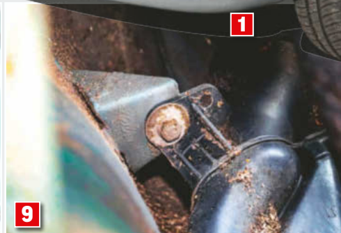
WLEW PALIWA. Korozję mocowania zdradzają dopiero pęcherze przy klapce wlewu paliwa.
