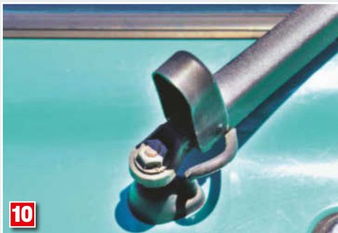
TYLNA WYCIERACZKA. Jeśli oś pod klapką się zapieczę, silniczek wkrótce odmówi współpracy.
