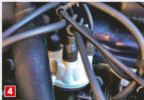
4 POKRYWA ROZDZIELACZA ZAPŁONU. Psuje się, więc warto wozić w aucie zapasową kopułkę.
