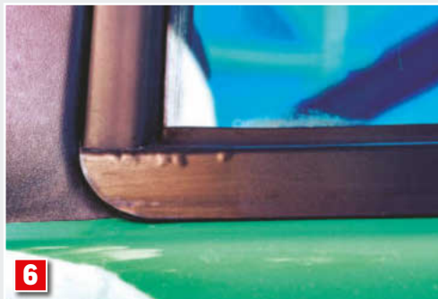
6 USZCZELKI I LISTWY. Pęcherze świadczą o korozji metalowego rdzenia. Zostaje wymieniana część na nową.
