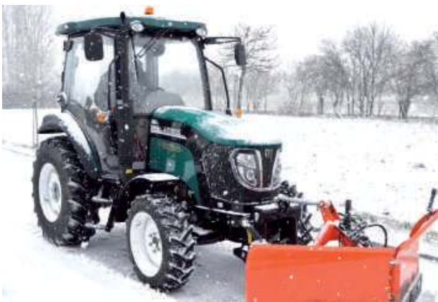
Nowa maszyna wyposażona jest w napęd na cztery koła, czterocylindrowy silnik zapewnia moc 50 KM, przedni tuz, klimatyzację i obciążniki na koła, dwubiegowy WOM, wydajną hydraulikę oraz posiada stosunkowo małe gabaryty, dzięki czemu świetnie nadaje się do prac komunalnych
