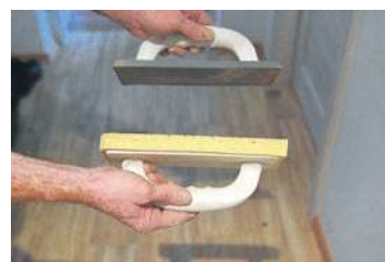
Packi potrzebne przy nakładaniu fug.
