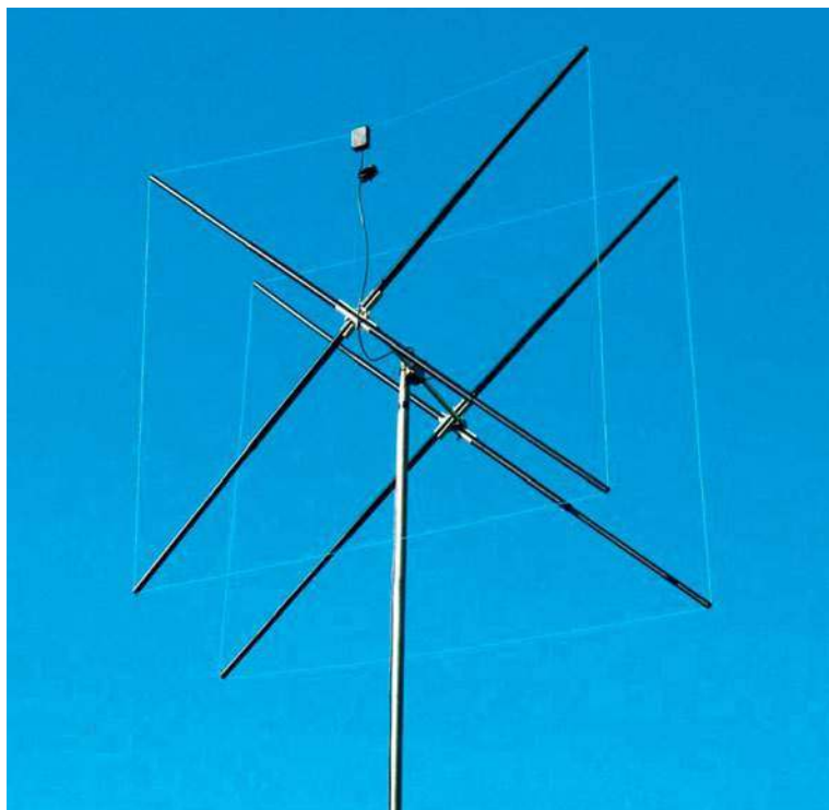
Fot. 1. Widok zainstalowanej anteny dla pasma 6 m
