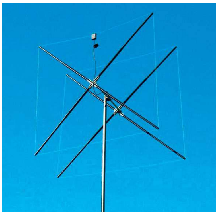
Fot. 1. Widok zainstalowanej anteny dla pasma 6 m
