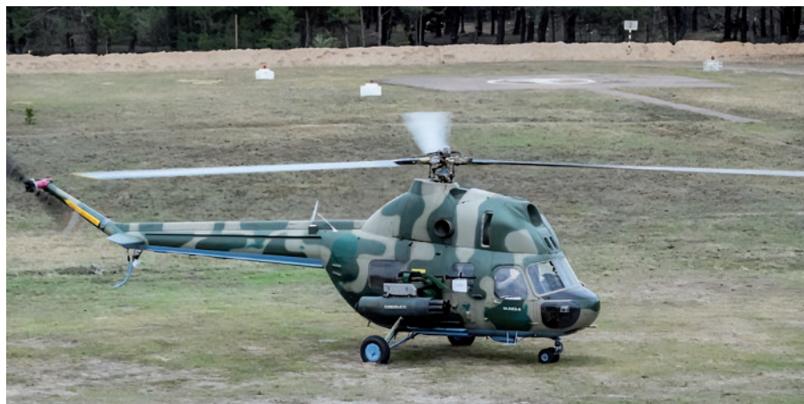
▲ Śmigłowiec Mi-2MSB-W, uzbrojony w niekierowane pociski rakietowe S-8 (w wyrzutniach B8W8MSB) oraz wkm NSWT-12,7 podczas prób na poligonie Honczariwskie (obwód czernihowski) w 2021 r. W praktyce lotnictwo armijne używało Mi-2 wyłącznie w wariantach bez uzbrojenia.
