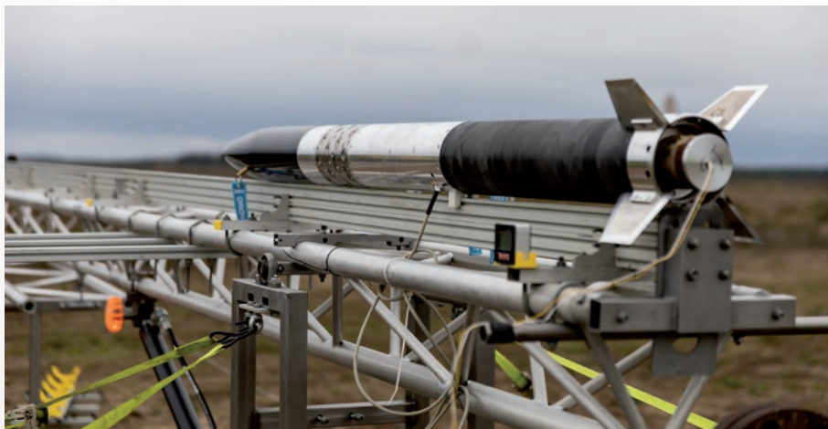
▲ Pocisk RPT Orion przygotowany do startu na wyrzutni przed podniesieniem prowadnicy do pozycji startowej. Widoczne podłączone do pocisku dwa przewody: pierwszy przeznaczony do komunikacji ze stacją bazową GNSS, a widoczny z tyłu pocisku drugi przewód służy do uruchomienia silnika głównego.
