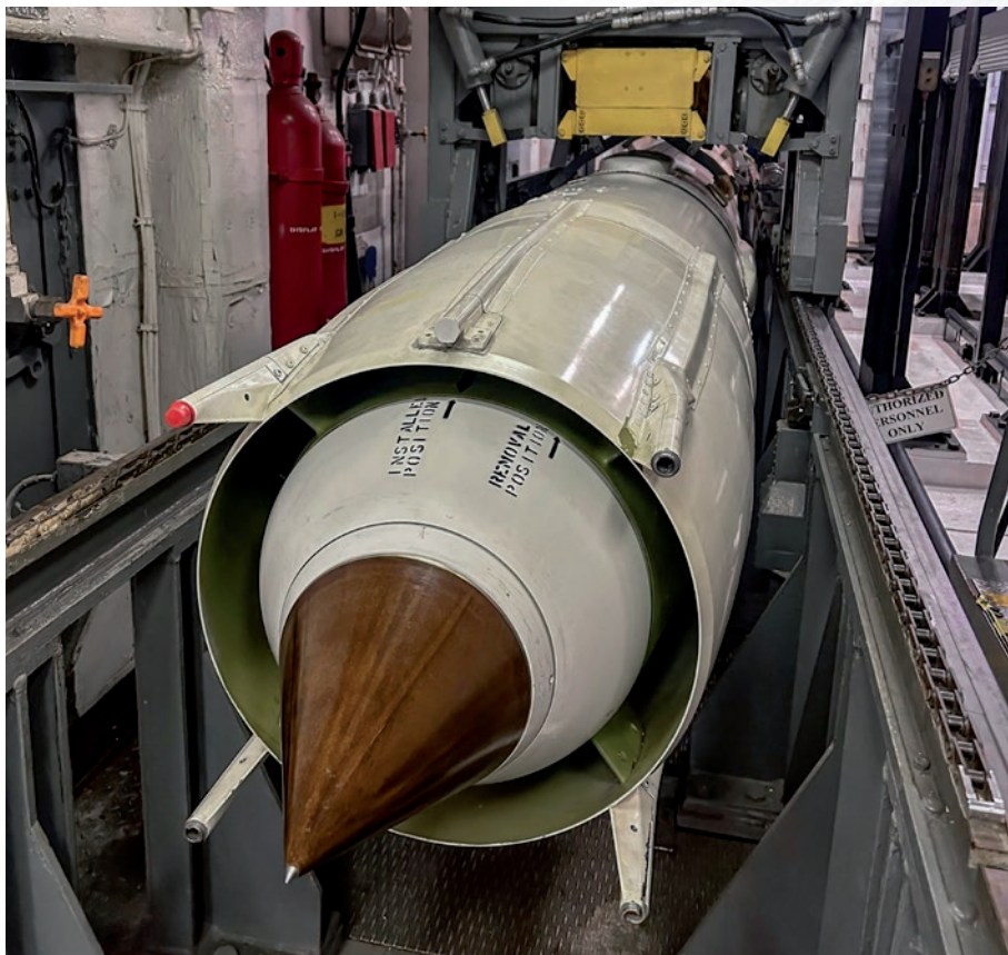
▲ Ciężki przeciwlotniczy pocisk rakietowy dalekiego zasięgu RIM-8 systemu Talos . Był to klasyczny rodzaj efektora wykorzystującego rzeczywisty system przewodnicowy (Mk 7 GMLS lub nowszy Mk 12 GMLS), całkowicie odmienny konstrukcyjnie od współczesnych wyrzutni pionowego startu.
