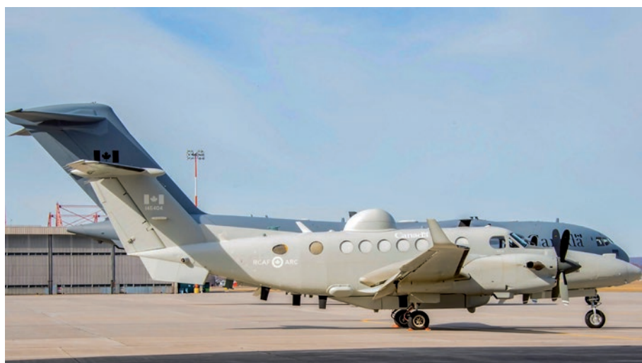
▲ Beechcraft King Air 350ER w konfiguracji ISR (CE-145C Vigilance ) to samoloty przeznaczone do zwiadu, obserwacji i rozpoznania obrazowego i elektronicznego na rzecz Sił Operacji Specjalnych. Trzy maszyny tego typu zostały dostarczone w 2024 roku.
