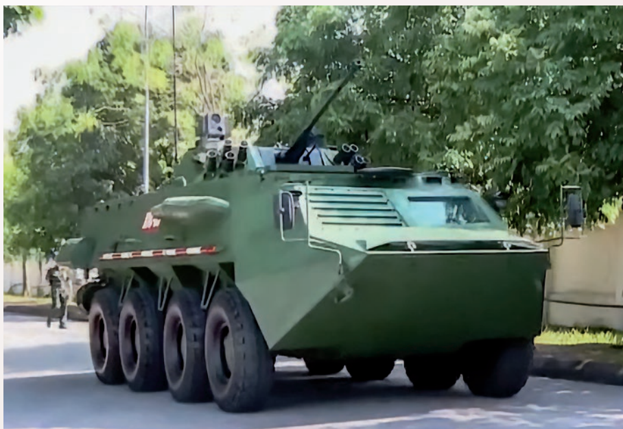
▲ Kołowy transporter opancerzony XTC-03, w którym wieża jest podobna do skonstruowanej przed 50 laty radzieckiej dla BMP-2.
