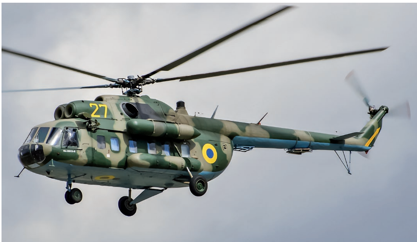
▲ Zmodernizowany śmigłowiec Mi-8MSB-W (numer boczny żółty „27”), przebudowany z pasażerskiego Mi-8P (na co wskazują prostokątne, a nie okrągłe, okienka kabiny ładunkowej).
