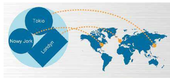
Rys. 4. Obszar obejmujący grupę abonentów może być dzielony na dowolnie rozmieszczone na kuli ziemskiej części o kształtach kołowych, kwadratowych lub prostokątnych. W przykładzie obejmuje on rejony Tokio, Nowego Jorku i Londynu
