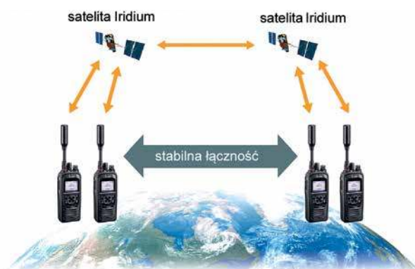
Rys. 2. Zasada łączności satelitarnej przy użyciu radiotelefonów IC-SAT100
