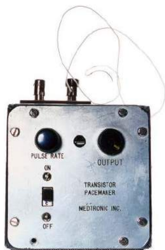
Fotografia 6. Pierwszy, zewnętrzny rozrusznik baterijny Bakkena ( https://t.ly/K-8t )
