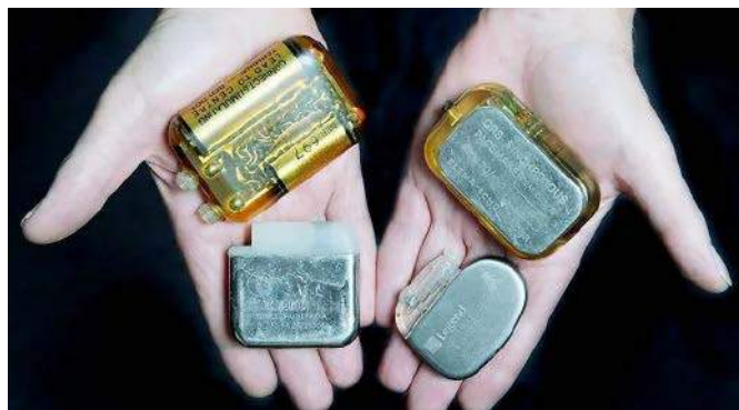
Fotografia 13. Rozwój rozruszników serca oraz ICD wiązał się z nieuchronną miniaturyzacją urządzeń we wszystkich trzech osiach, choć największa różnica między starszymi, a nowszymi konstrukcjami, jest widoczna na grubości obudowy ( https://t.ly/feng )
