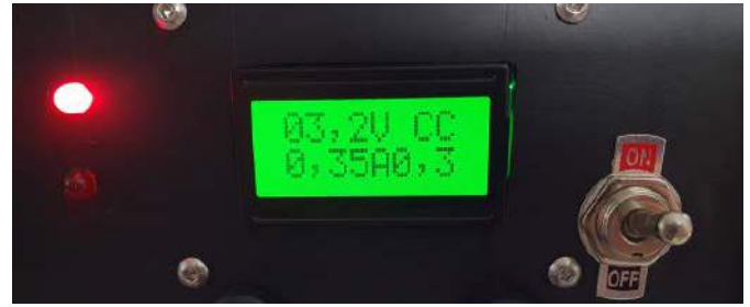
Fotografia 8. Wygląd płyty przedniej po zadziałaniu układu ograniczenia prądowego
