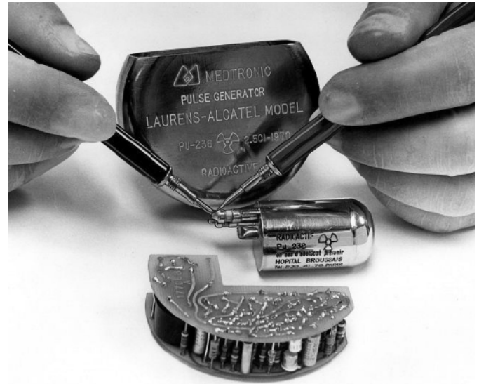
Fotografia 18. Wnętrze rozrusznika marki Medtronic z zasilaniem nuklearnym. Widoczny (zamknięty w osobnej obudowie) radioizotopowy generator termoelektryczny ( https://t.ly/eX_5 )
