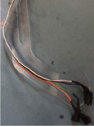
Fotografia 5. Akrylowy element, po wycięciu i uformowaniu z użyciem opalarki
