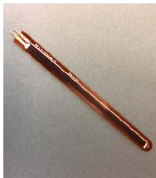
Fotografia 1. 100-milimetrowy jednokierunkowy sensor zginania firmy Flexpoint Sensor Systems
