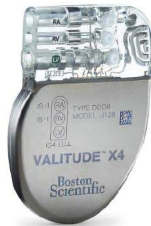
Fotografia 12. Stymulator resynchronizujący (CRT-P) marki Boston Scientific. Widoczne oznaczenia gniazd elektrod: dwa główne złącza IS-1 (dla prawego przedsionka i prawej komory) oraz jedno IS-4 w konfiguracji LLLL (https://t.ly/4Gb5)
