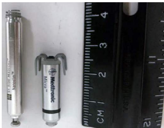
Fotografia 9. Porównanie rozmiarów dwóch rozruszników bezelektrodowych: Nanostim (St. Jude) i Micra TPS (Medtronic). Źródło: https://t.ly/gjdm
