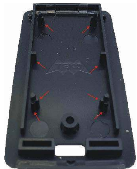
Fotografia 3. Wygląd wnętrza dolnej części obudowy z zaznaczeniem nadlepek przeznaczonych do usunięcia
