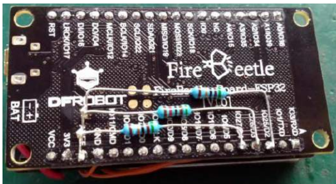
Fotografia 2. Oporniki podciągające na płytce (uwaga – oporniki powinny podłączać do pinu 3V3, a nie AREF, jak na zdjęciu)
