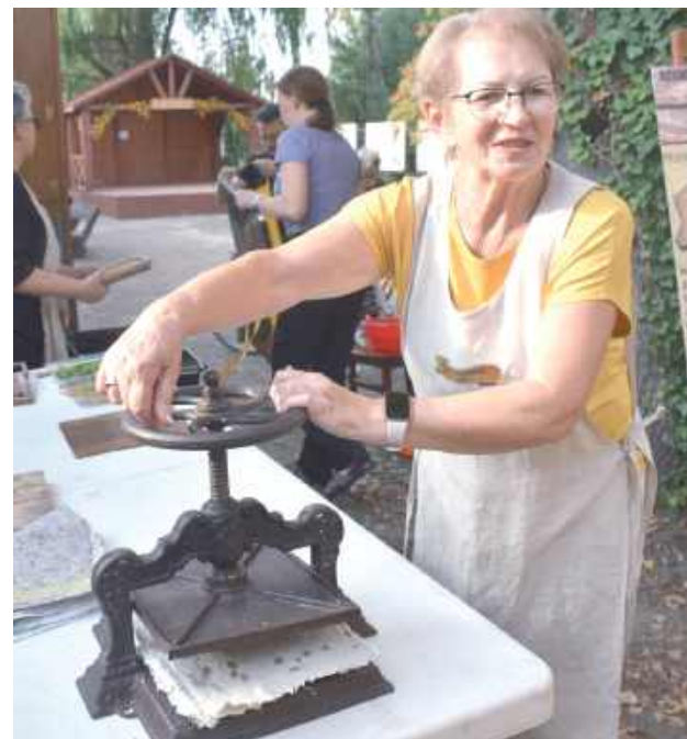
W tym urządzeniu kartki przygotowane przez uczestników warsztatów czerpania papieru były wyciskane, a następnie przekładane do suszenia
