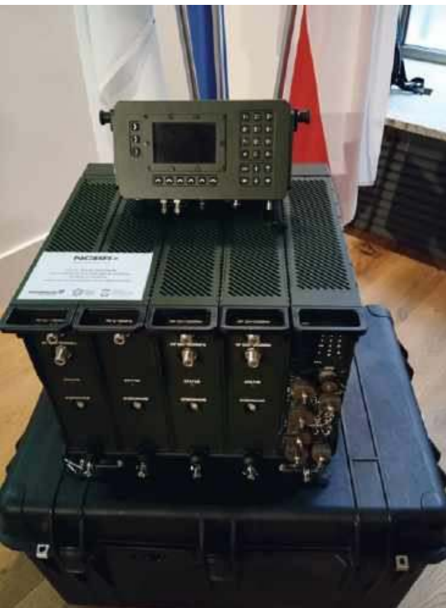
Radiostacja Guarana w konfiguracji czterokanałowej z blokiem kryptograficznym
