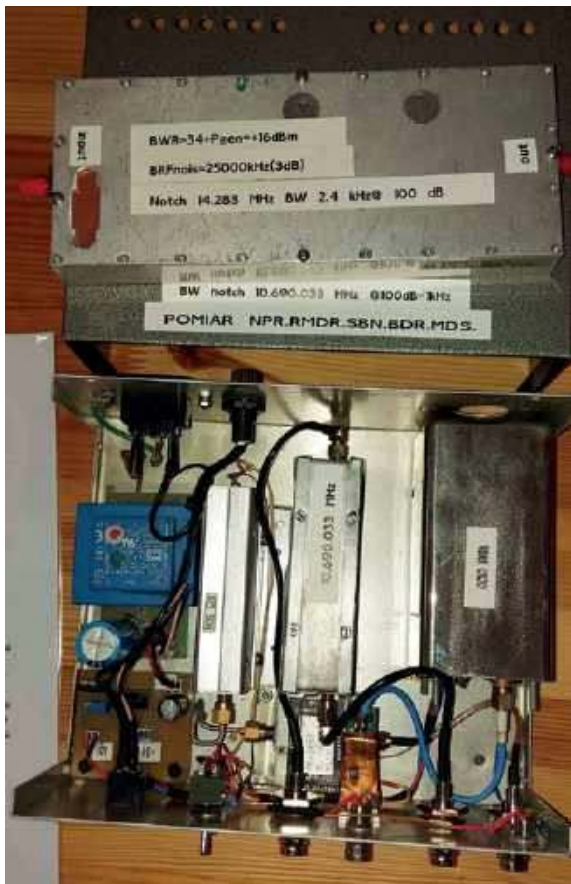
Rys. 6. Pomiar szerokości pasma filtr szumów BRF – 16,4 MHz
