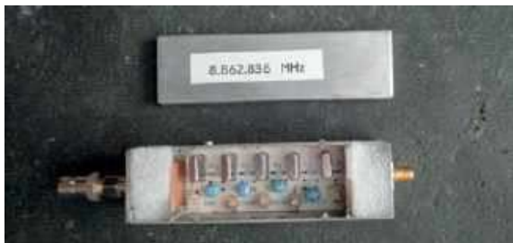
Notch filtr 8.862,836 MHz (B – podstawy notcha 1,5 kHz)
