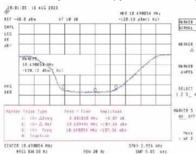
Rys. 4. Pomiar szerokości notcha w podstawie filtra 10,690033 MHz
