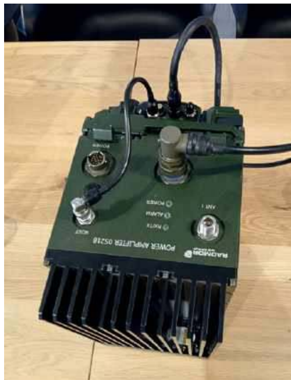
Radiostacja COMP@N z adapterem i wzmacniaczem mocy do stosowania w pojazdach
