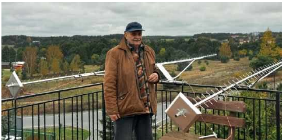
Anteny Yagi 42-elementowe do łączności przez Księżyc i ich konstruktor Janusz SP2CNW
