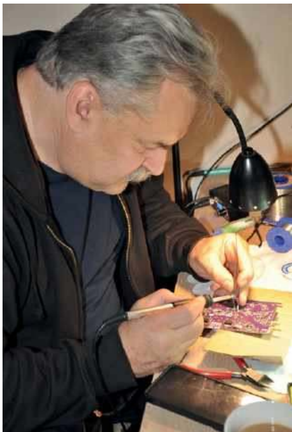
Marek SP4ELF lutuje płytkę urządzenia na 24 GHz
