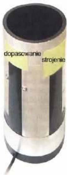
Zamaskowana antena wykonana z rury z PCW z naklejoną folią metalową. Widoczne na zdjęciu śruby stanowią zaciski anteny. U góry widoczne odcinki folii metalowej służącej do dostrojenia i dopasowania anteny przez zmianę miejsca zwarcia
