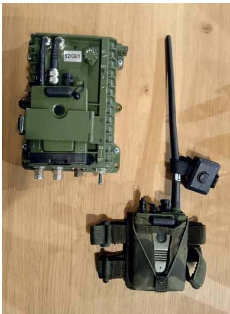
Radiostacja osobista R35010 i w wersji ze wzmacniaczem pojazdowym, umożliwiającym tworzenie funkcjonalnej sieci łączności dla jednostek pancernych, zmechanizowanych lub zmotoryzowanych
