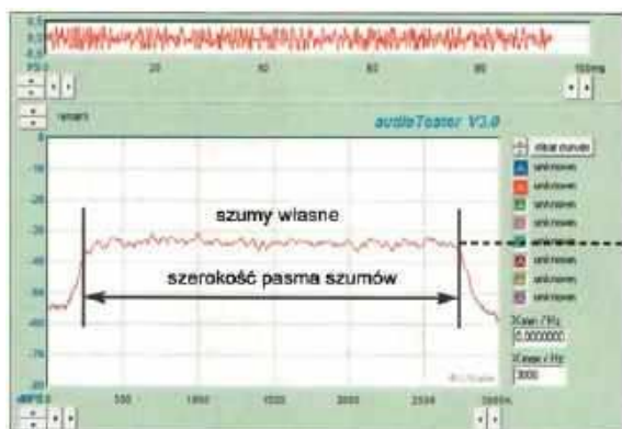
Rys. 2. Wyniki analizy FFT szumów m.cz. Szerokość pasma szumów wynosi w przybliżeniu 2,8 kHz
