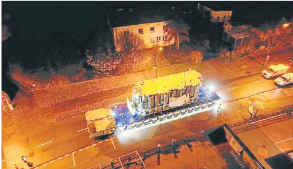
Transformatory na teren budowy nocą przewieziono z portu we Władysławowie
