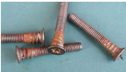
Rysunek 9. Śruby kotwiące umożliwiają przyciągnięcie śruby do drewna. Nie odkręcają się one podczas dokręcania nakrętki, ponieważ gwint w drewnie jest odwrócony
