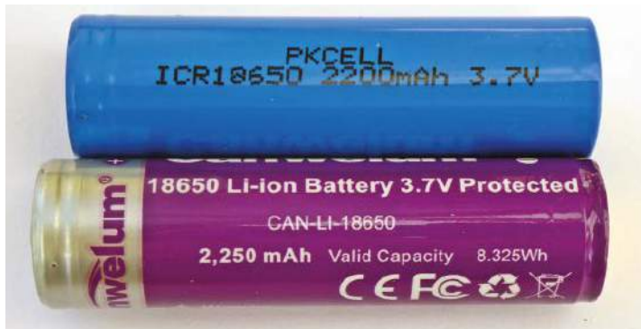
Rysunek 8.5. Zabezpieczone (dół) i niezabezpieczone (góra) ogniwa 18650 3,7 V.
