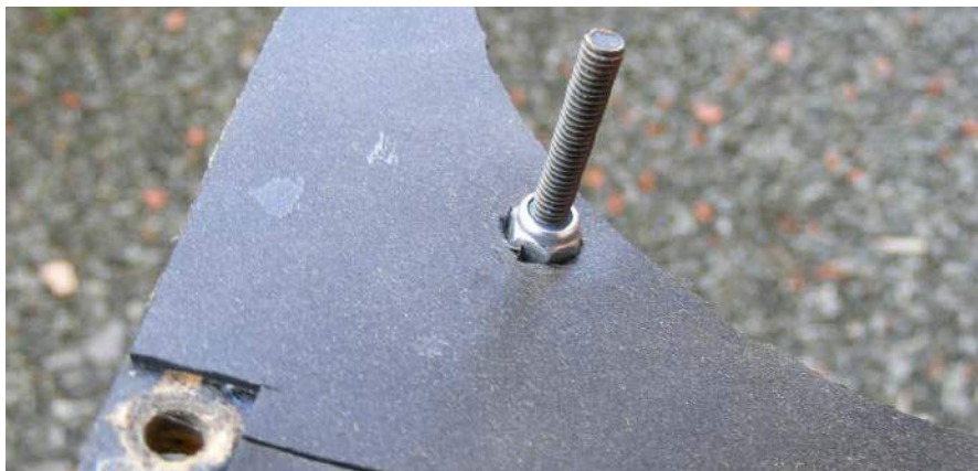
Rysunek 10. Choć w oryginalnym LS3/5A stosowano śruby kotwiące, ja unikam ich stosując zwykłą śrubę z nakrętką
