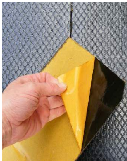
Rysunek 15. Arkusze tłumiące do karoserii – muszą być sklejone ze sobą, aby stworzyć właściwą podkładkę tłumiącą pod głośnik
