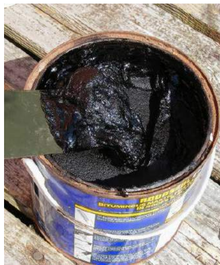
Rysunek 16. Aquaseal 88 jest doskonałym bitumiczną masą do sklejania papy dachowej w celu stworzenia paneli tłumiących. Trzymać z dala od białych dywanów, białych kotów... zawsze stosować na zewnątrz!
