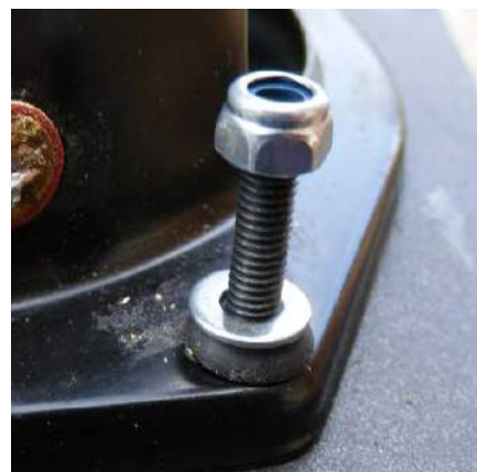
Rysunek 6. Nakrętka samozabezpieczająca nie wymagająca stosowania podkładek zabezpieczających i nie obluźwiają się
