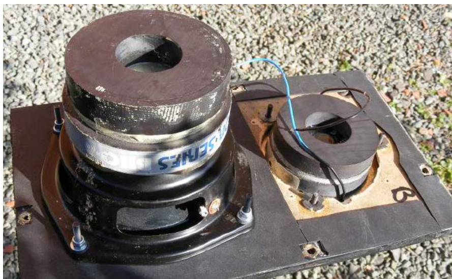
Rysunek 13. Nakrętki typu T zostały włożone do przegrody dla głośnika wysokotonowego T27. Nałożono odrobinę kleju, aby zapobiec ich wypchnięciu, co zdarza się w przypadku zbyt dużego nacisku podczas dokręcania śrub. (Należy zwrócić uwagę na dodatkowe magnesy ekranujące przyklejone do przetworników – zostaną omówione w innym artykule!)
