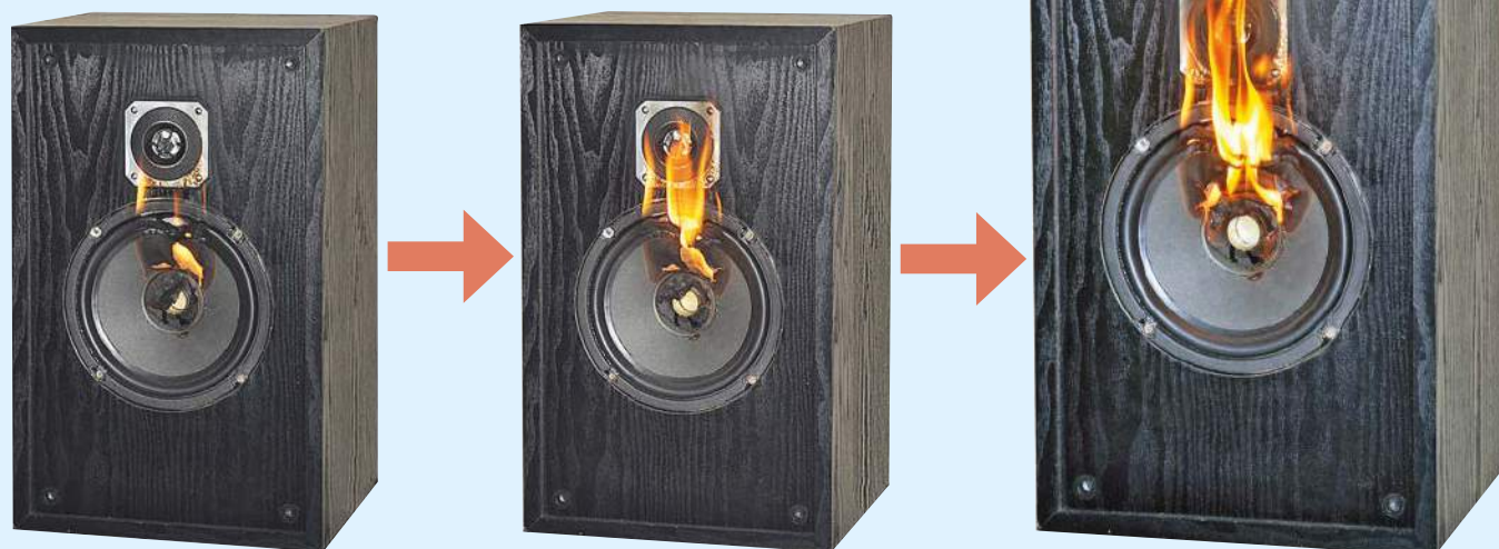
Bez układu zabezpieczenia poważna usterka we wzmacniaczu dużej mocy może spowodować przepływ prądu przez cewkę głośnika o natężeniu wystarczającym do jego zapalenia się. Te trzy zdjęcia, wykonane w odstępach 3-sekundowych, ilustrują jak szybko może dojść do pożaru po zapaleniu się membrany.
