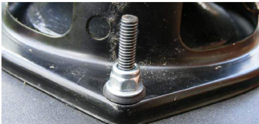
Rysunek 12. Ostateczny układ montażowy dla B110. Należy zwrócić uwagę na nakrętkę Nyloc i zwykłą podkładkę, aby zapobiec miażdżeniu przepustu podczas dokręcania
