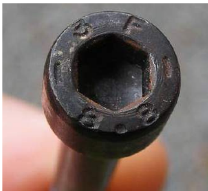
Rysunek 3. Śruby z gniazdem sześciokątnym dokręcone kluczami imbusowymi znacznie zmniejszają szansę na uszkodzenie membrany przez wyslizgujący się śrubokręt
