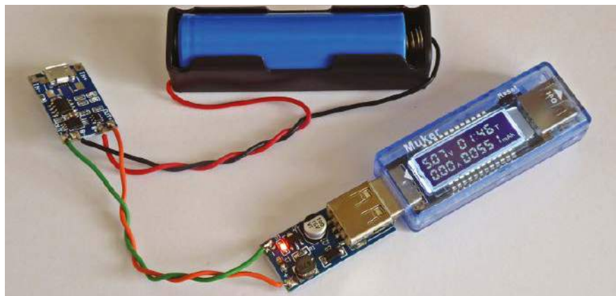
Rysunek 8.10. UPS USB. Od lewej do prawej: Kontroler ładowania USB; niebezpieczne ogniwo 18650 3,7 V; kontroler rozładowania i monitor napięcia/prądu.
