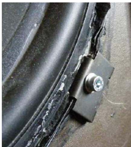
Rysunek 7. Dostępne są specjalistyczne zaciski głośnikowe do mocowania głośników na obrzeży
