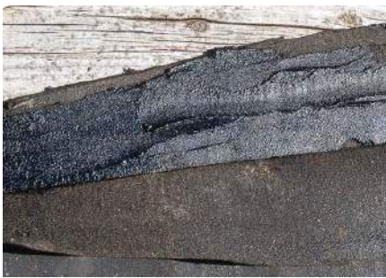
Rysunek 17. Powlekanie papy mazią w celu wykonania wielowarstwowej płyty tłumiącej
