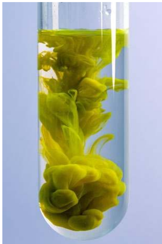
Fot. 1 – Wytrącający się z roztworu osad jodku ołowiu(II)
