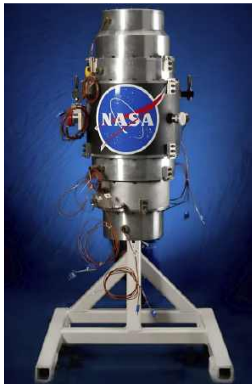
1. Opracowana przez NASA bateria z kołem zamachowym
