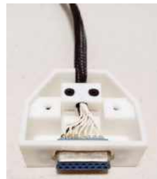
Fotografia 12. Uchwyt kabla zintegrowany z obudową
