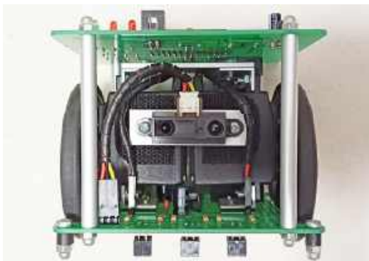
Fotografia 5. Zastosowanie spiralnej owijki do zabezpieczenia przewodów
