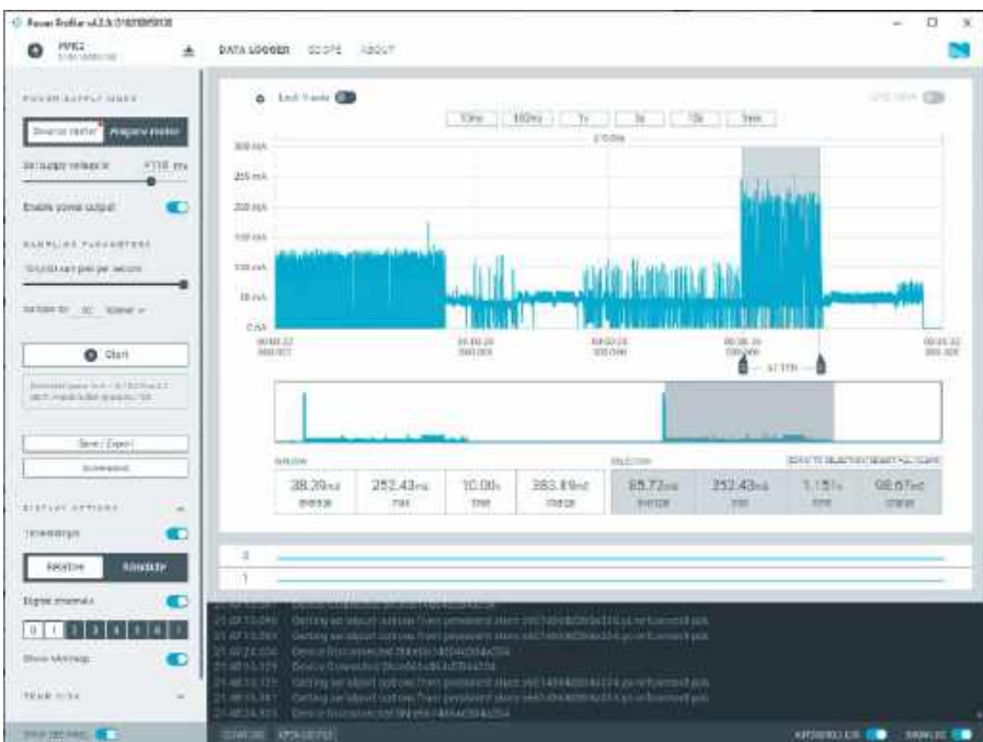
Rysunek 2. Pobór prądu płytki Enviro Weather (zasilanie z wejście BATT)
