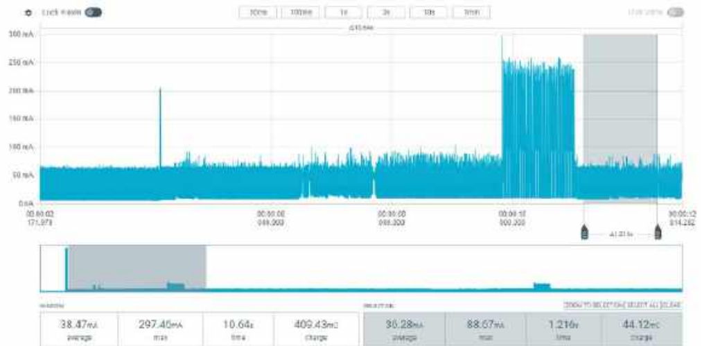
Rysunek 3. Pobór prądu płytki Enviro Weather (zasilanie z USB)
