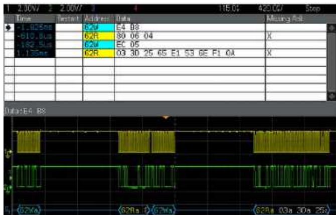
Rysunek 1. Odczyt znacznika gotowości danych oraz danych pomiarowych czujnika SCD41
