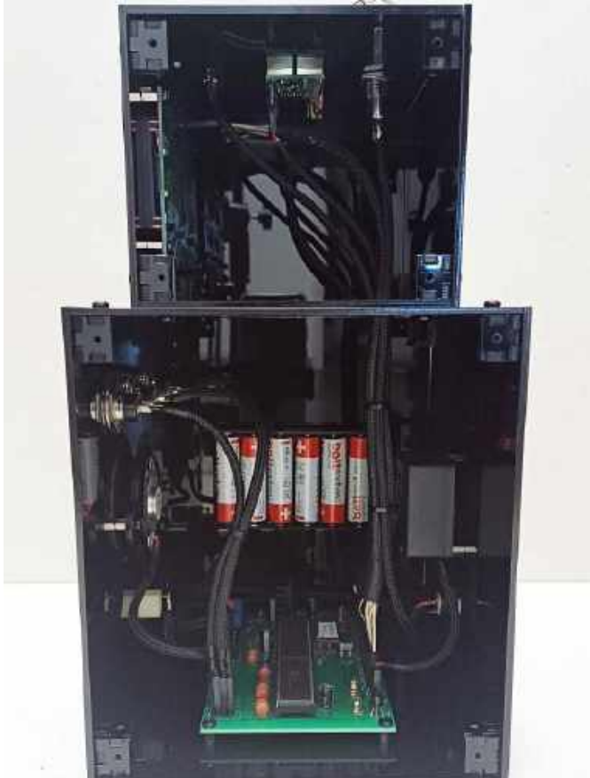
Fotografia 4. Połączenia pomiędzy płytką drukowaną a komponentami elektronicznymi znajdującymi się na obudowie urządzenia
