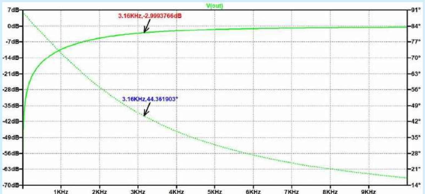
Rysunek 10. Charakterystyka częstotliwościowa prostego, górnoprzepustowego filtra RC (symulacja)
