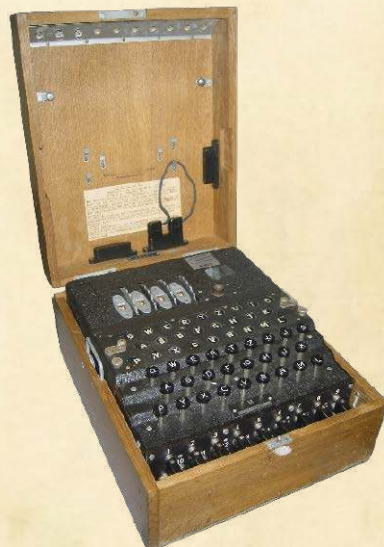
4. Wojskowa maszyna szyfrująca Enigma M4, wersja używana przez Kriegsmarine (Von Magnus Manske – Created by Magnus Manske., CC BY-SA 3.0, https://commons.wikimedia.org/w/index.php?curid=395109 )
