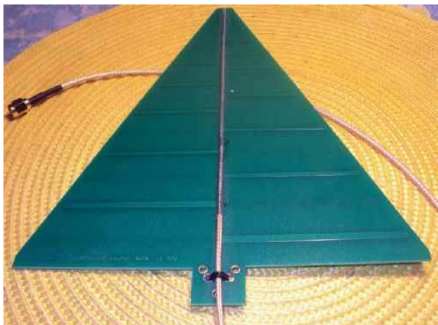
Antena logarytmiczno-periodyczna obejmująca pasma 23–6 cm
