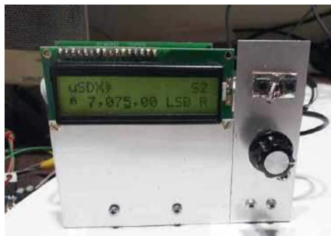
Eksperymentalny transceiver \mu SDX konstrukcji PY2OHH
