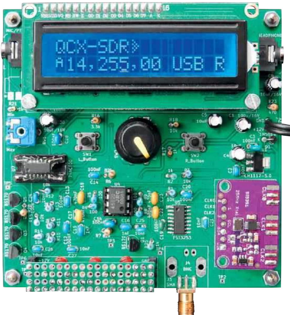
Transceiver \mu SDX z uruchomioną częścią odbiorczą przez SQ6IUS
