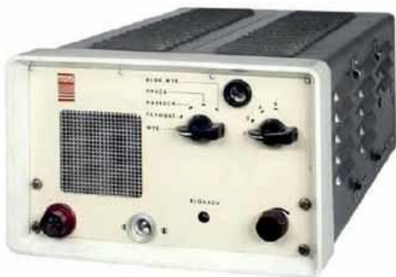
Lampowy radiotelefon przewoźno-stacjonarny FM-302
