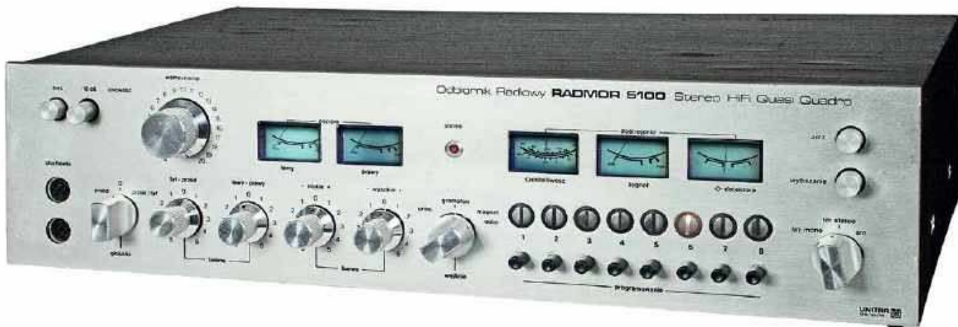
RADMOR 5100 – pierwszy odbiornik radiowy firmy RADMOR w jednej obudowie ze wzmacniaczem
