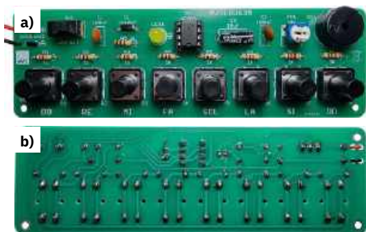
Fotografia 19. Poprawnie zmontowany układ Mini-pianino. Widok płytki a) od strony komponentów; b) od strony lutowania
