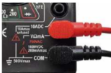
Fotografia 16. Poprawne podłączenie kabli na przyłączu multimetru DT-830B, ustawionego na funkcję woltomierza napięć stałych
