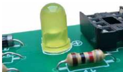
Fotografia 10. Przykład poprawnie zamontowanej diody LED. Płaskie ścięcie na obwodzie diody LED, symbolizujące katodę, musi pokrywać się z fragmentem linii prostej w obrysie komponentu zaznaczonym na płycie
