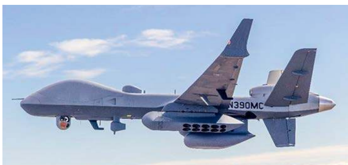
Morski patrolowy MQ-9B SeaGuardian z widocznym zasobnikiem sonoboi pod skrzydłem oraz radarem przeszukującym powierzchnię morza pod kadłubem. Fot. General Atomics
