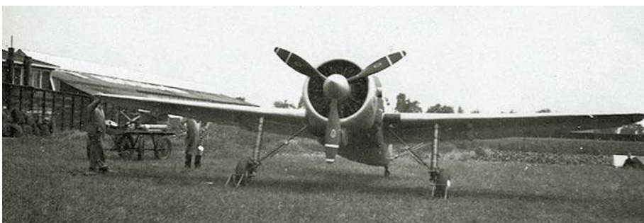
Widok z przodu pierwszego prototypu. Zwraca uwagę szeroki rozstaw kół podwozia.
