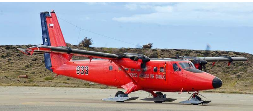
Lekki samolot transportowy DHC-6-300 Twin Otter (933) z 6. Grupy Lotniczej z Punta Arenas. Twin Ottery są wykorzystywane do przewozu ludzi i ładunków, ewakuacji medycznej oraz poszukiwania i ratownictwa. Operują także na Antarktyce.
