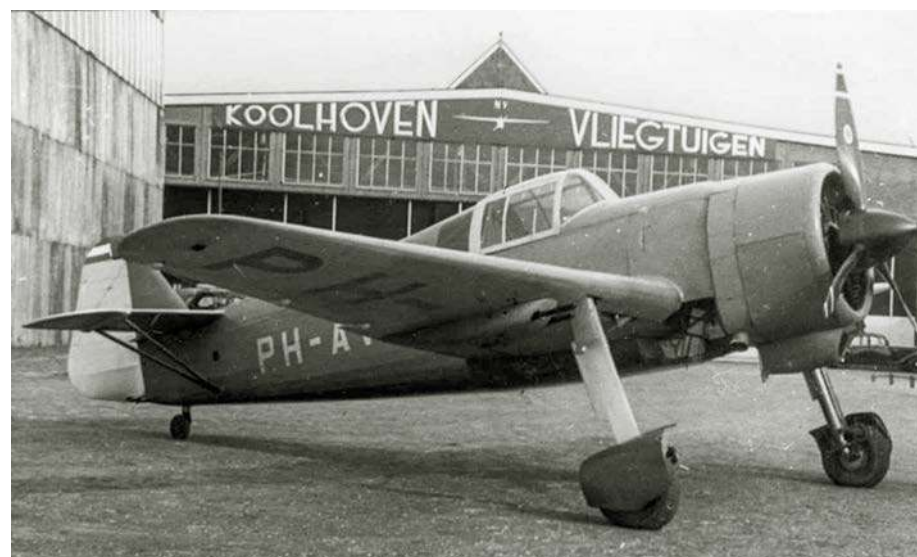
Drugi prototyp FK.58 przed hangarem z zainstalowaną pod skrzydłem gondolą z dwoma karabinami maszynowymi FN-Browning Mle38 kal. 7,5 mm.
