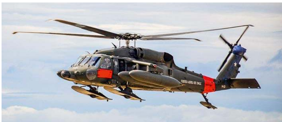
Śmigłowiec transportowy MH-60M Black Hawk (H-03) z 9. Grupy Lotniczej z Pudahuel koło Santiago. W 2016 roku kupiono sześć maszyn przeznaczonych do operowania głównie w rejonie Antarktyki i wysokich Andach. Śmigłowce zostały wyprodukowane w polskich zakładach PZL Mielec. Jeden z nich utracono 16 października 2025 roku.
