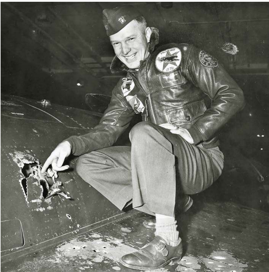
Lt. Williams wskazujący po powrocie z legendarnego starcia uszkodzenie swojego samolotu pociskiem kal. 37 mm wyrzucenym przez radziecki myśliwiec. Uwagę zwraca duża liczba przebieg pokrycia od odłamków pocisku, których suma w licznych publikacjach uważana jest za liczbę przestrzelin.
