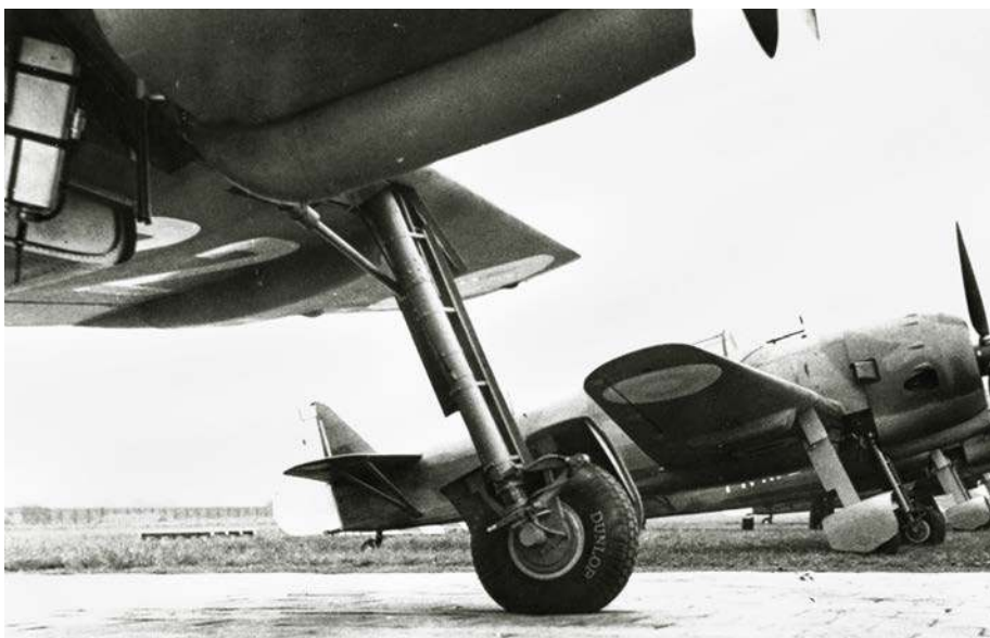
Szczegóły gołenii podwozia głównego jednego z FK.58 przygotowanych do wysyłki do Francji w sierpniu 1939 roku.
