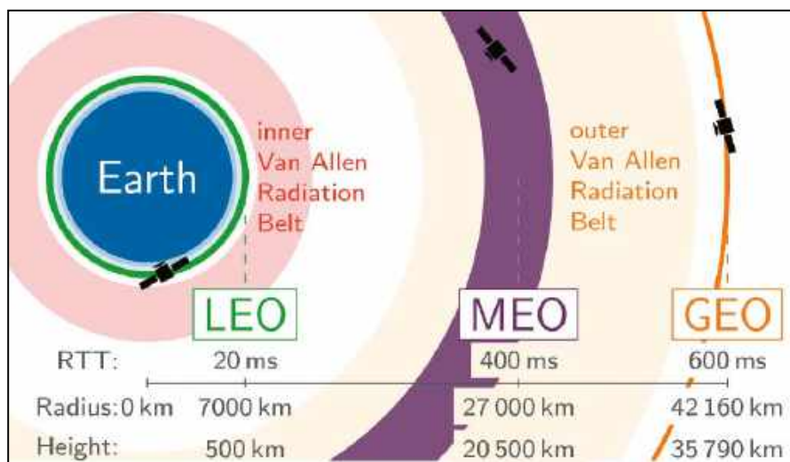
Rysunek 2. Porównanie cech kilku wysokości orbitalnych. RTT to czas podróży sygnału radiowego w obie strony. Najlepiej unikać pasów radiacyjnych Van Allena. Promień jest liczony od środka Ziemi, natomiast wysokość jest liczona od powierzchni Ziemi. Źródło: https://w.wiki/6H8X
