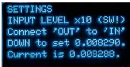
Ekran 5. Zgodnie z instrukcjami na ekranie, ustawiamy przełącznik na 10x. Jeśli S6 jest w niewłaściwej pozycji lub sygnał nie jest wykrywany, pojawi się komunikat. Współczynnik zatwierdzamy przyciskiem DOWN, a następnie OK
