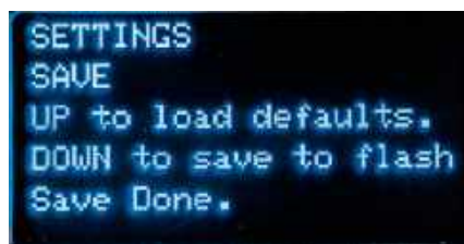
Ekran 6. Ekran ten pojawi się, gdy nacisniemy OK ponownie. Wciskamy DOWN, aby zapisać wartości parametrów kalibracji w pamięci FLASH. Pojawi się komunikat potwierdzający wykonanie tej czynności
