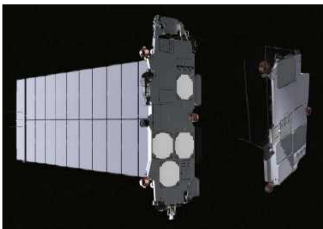
Rysunek 5. Renderowanie satelitów StarlinkV1.5 (po lewej) i V1 (po prawej). Satelity V2.0 mają pięciokrotnie większą powierzchnię anten skierowanych na Ziemię i są znacznie bardziej wydajne. Źródło: www.teslarati.com/spacex-elon-musk-next-gen-starlink-satellite-details/
