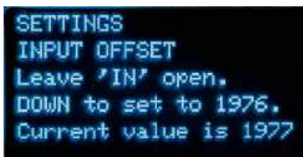
Ekran 2. Gdy jest znajdowany poziom INPUT OFFSET, wejście musi pozostawać niepodłączone. Czekamy aż wyświetlana wartość się ustabilizuje. Wartość tę zapisujemy przyciskając DOWN, a następnie wciskamy OK
