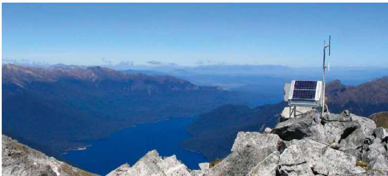
Rysunek 23. Zestaw czujników umieszczony na szczycie góry, połączony z systemem Swarm. Źródło: https://swarm.space/
