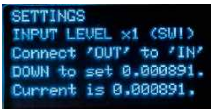
Ekran 4. Aby wykonać kolejne kroki kalibracji, łączyliśmy kablem z wtykami RCA wyjście z wejściem. Upewniamy się, że przełącznik zakresu S6 jest ustawiony na 1x. Po wyświetleniu wiersza załaty naciskamy DOWN, a następnie OK
