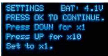
Ekran 1. Po pierwszym załączeniu analizatora naciskamy MODE aż przejdziemy do strony SETTINGS w celu wykonania kalibracji. Aby ją rozpocząć, naciskamy OK
