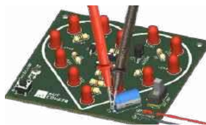
Rysunek 14. Pomiar napięcia na kondensatorze C1 po ustawieniu SW1 w pozycji ON
