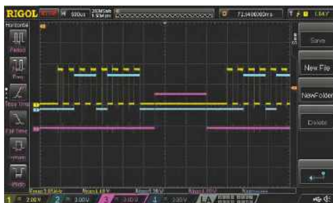
Rysunek 7f. Komunikacja szeregowo po SPI: kanał żółty – SCLK, kanał niebieski – SDATA, kanał fioletowy – strobe/latch
