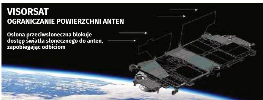
Rysunek 17. Osłona została dodana do późniejszych satelitów Starlink, aby zmniejszyć ilość światła odbijanego w kierunku Ziemi. Źródło: takie samo jak na rysunku 15
