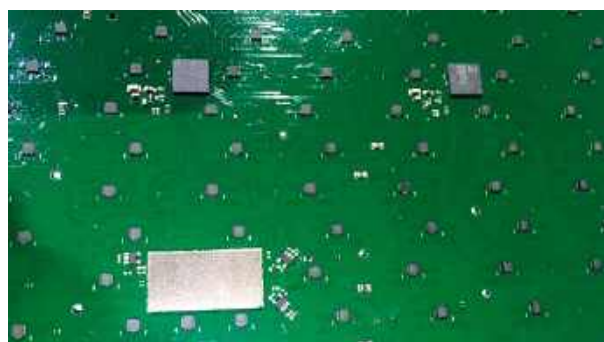
Rysunki 10 i 11. Część płytki PCB anteny Starlink. Ścieżki PCB są zakrzywione, aby zapewnić stałą długość wszystkich ścieżek (a sygnały RF nie lubią ostrych zakrętów). Źródło: https://youtu.be/AlvIWF0AXIO
