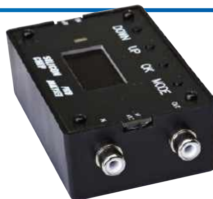
Na prawym boku obudowy są dwa otwory na gniazda RCA oraz wycięcie na przełącznik S6
