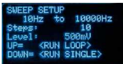
Ekran 11. W trybie SWEEP przyciski UP, DOWN i OK działają podobnie jak w trybie OUTPUT. Istnieje możliwość uruchomienia „przemiatania” pojedynczego lub wykonywania go w pętli
