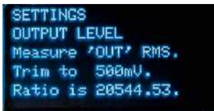
Ekran 3. Voltomierzem napięcia zmiennego lub innym przyrządem mierzymy wartość skuteczną sygnału na wyjściu i operujemy przyciskami UP i DOWN, aż miernik wskaże 500 mV. Następnie naciskamy OK
