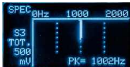
Ekran 8. Na stronie SPECTRUM przyciski UP i DOWN są używane do zmiany skalowania poziomego, natomiast OK przełącza skalę pionową między poziomem szczytowym i całkowitym
