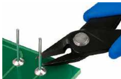
Rysunek 18. Właściwe miejsce cięcia nadmiaru wyprowadzeń po przylutowaniu komponentu. Po wykonaniu cięcia spoina powinna pozostać nienaruszona
