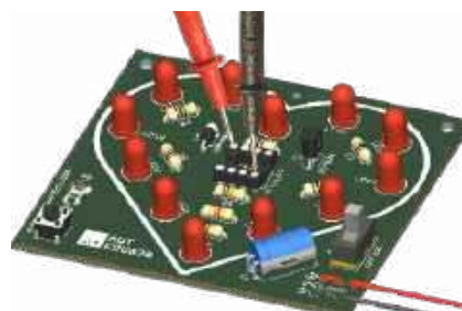
Rysunek 15. Pomiar napięcia zasilającego mikrokontroler na odpowiednich wyprowadzeniach podstawki po ustawieniu przełącznika SW1 w pozycję ON. Użyj schematu ideowego by ustalić właściwe wyprowadzenia lub skorzystaj z rysunku powyżej
