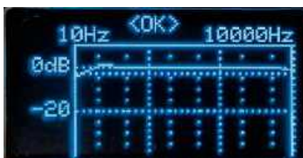
Ekran 12. Tutaj przyciski UP i DOWN zmieniają skalowanie pionowe. Nieoznakowana pozioma linia przerywana to poziom -3 dB w odniesieniu do poziomu wyjściowego analizatora
