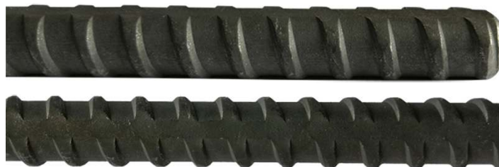
Rys. 2. Przykład nieocynkowanego ścigu gorączowalowanego z gwintem samoczyszczącym, wraz z podstawowymi wymiarami gwintu
